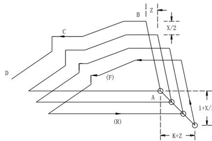
图 2.28 封闭轮廓复合循环 G73
