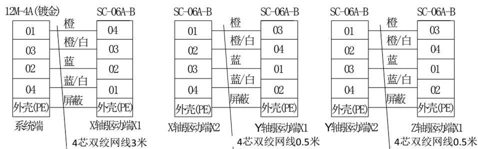
图 6.36 三轴总线接线方式
