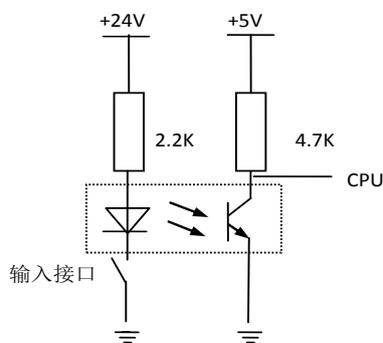
图 6.13 输入接口电路
