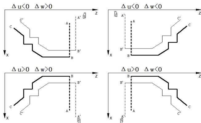
图 2.16 精车余量  $U(\Delta u)$ ,  $W(\Delta w)$  的方向与加工方向一览
