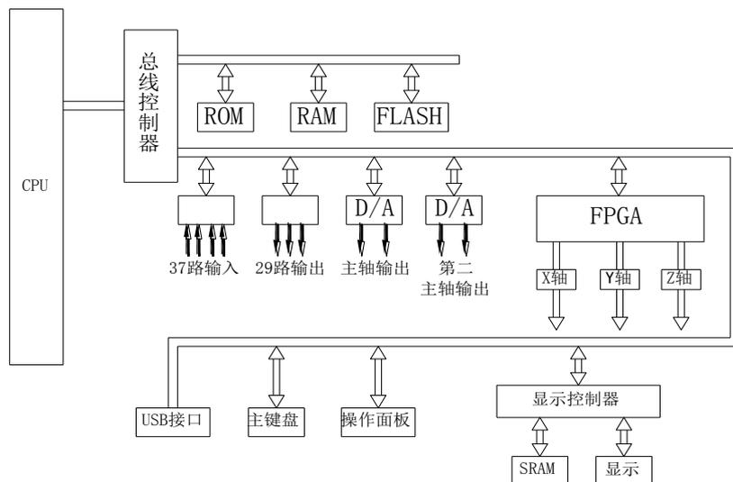
图 6.1 数控系统控制单元图
