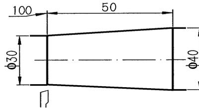
图 2.37 反向锥度外圆，进行右切削
