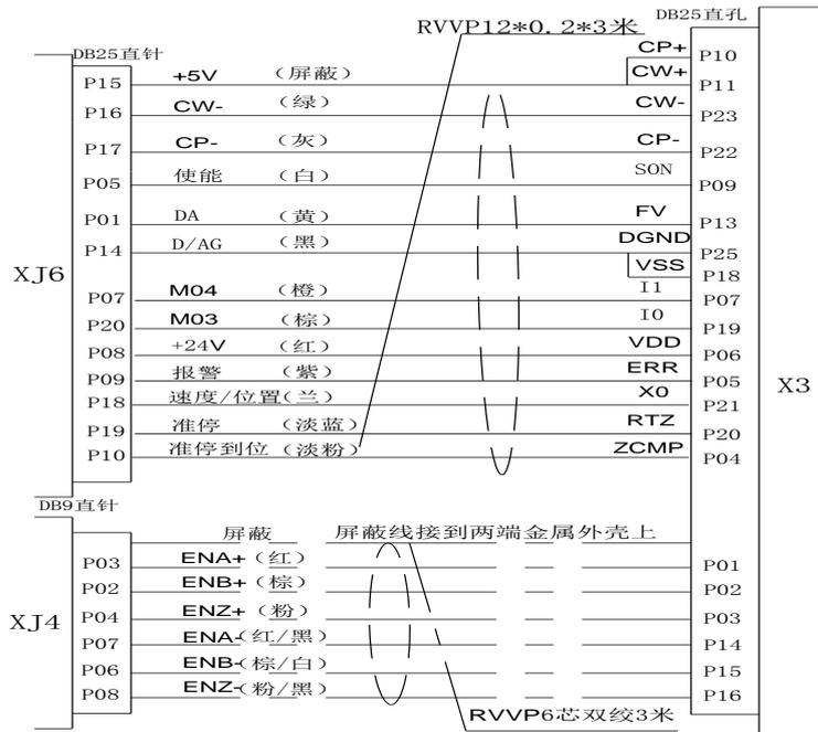
图 6.31 XJ6 信号口与 SPH040 主轴伺服驱动器 X3 连接图
