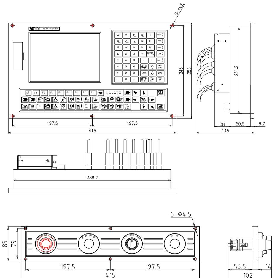
图 6.3 WA-715XTN 安装尺寸图以及附面板尺寸图
