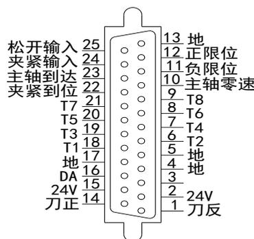
图 6.20 输入输出接口 XJ2 接口定义
