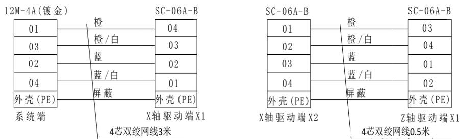
图 6.35 两轴总线接线方式
