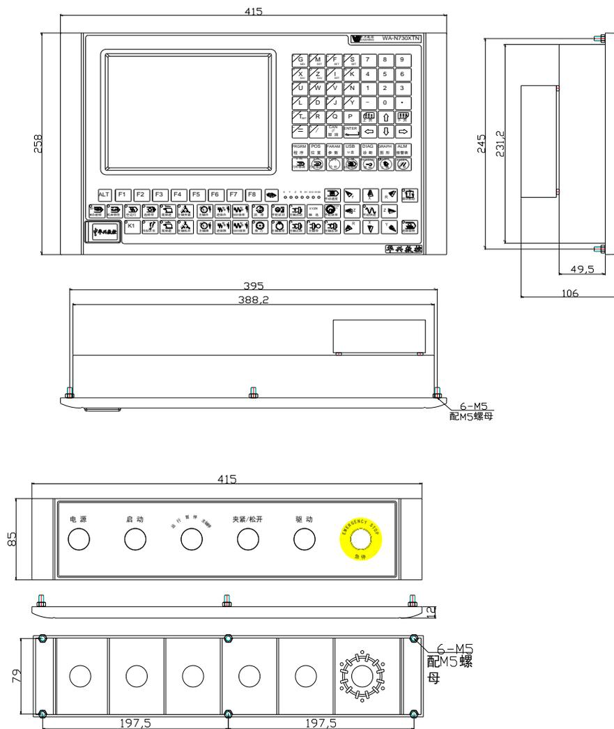
图 6.5 WA-N730XTN 安装尺寸图及附面板尺寸图
