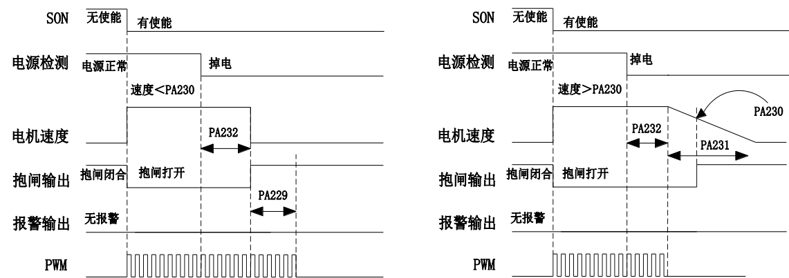
图 6-9 伺服驱动器“断电或瞬间断电”后的抱闸流程图
