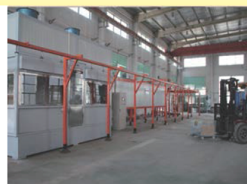
电机外表面自动喷漆线
