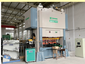
伺服电机定子高速冲生产线
